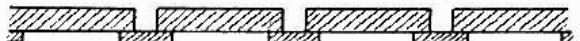
Listebeklædning af ru eller høvlede brædder med affasede dækklister. Ses brugt helt tilbage til 1700-tallet.
