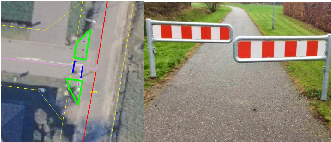
Figur 1: Stiuendung. Med grønt er markeret fremtidig græsribat og med blå stibomme forsynet med baggrundsafmærkning "O45". Med lilla er markeret kantafmærkningspæle til at øge synlighed for stiuendung for kørende trafik på Brunbjergvej.
