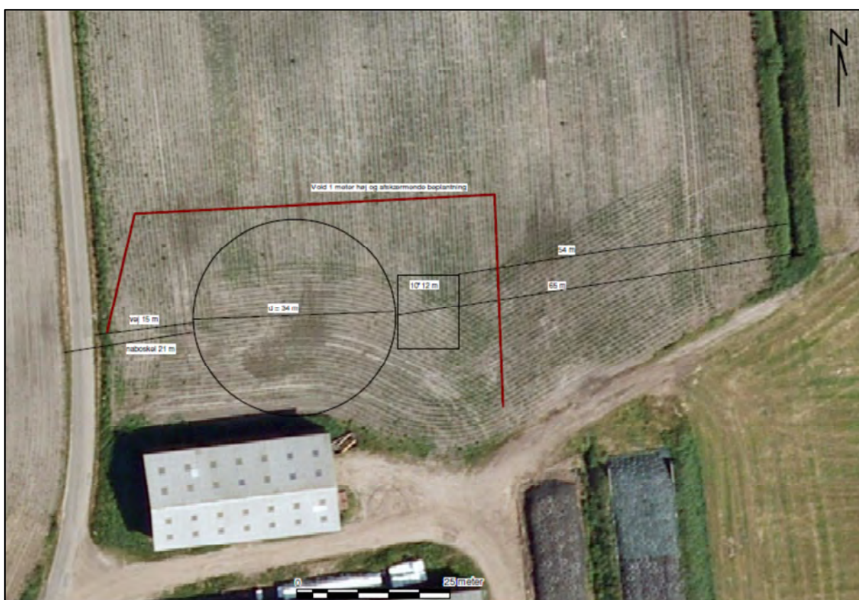
Kort 2. Placering af gyllebeholder og volden rundt om beholderen (indtegnet med rød).
