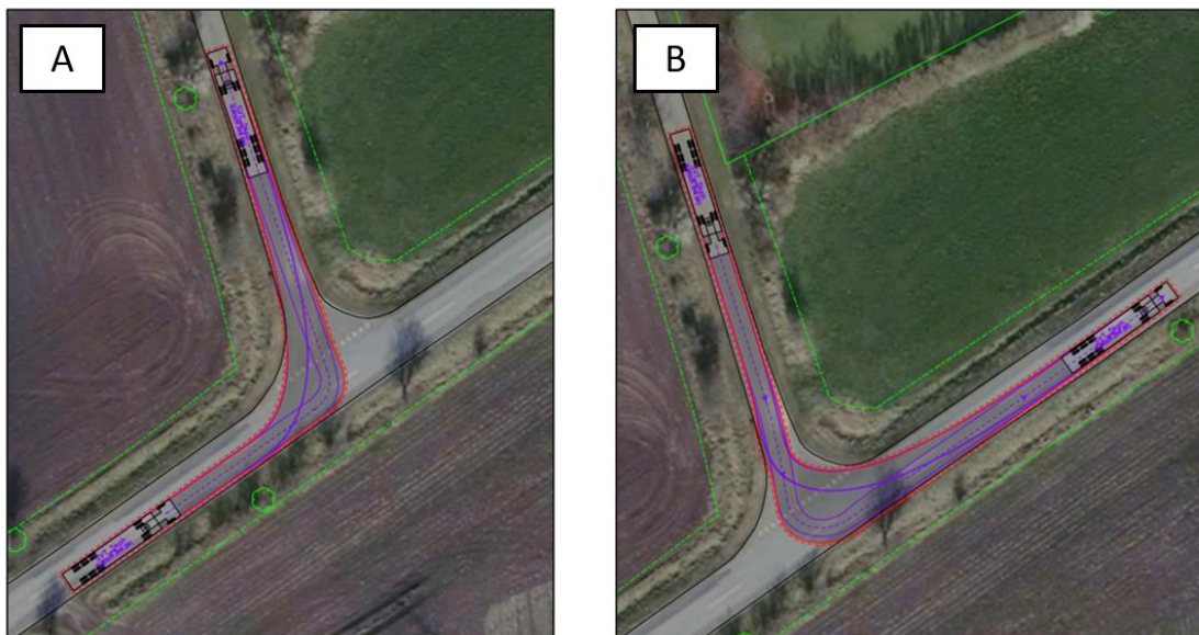
Figur 7-24: Kørekurver for venstresving i krydset Fogderupvej/Fogderup Nørremark. Køretøjstype: Sættevognstog.
